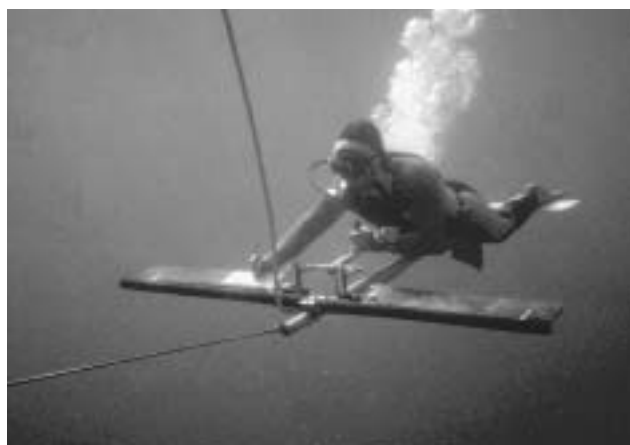
Fig. 3. Fotografía del acuaplano utilizado en los proyectos de bionomía. El buceador está conectado a un sistema de inmersión semi-autónomo, denominado narguilé , mediante el cual obtiene el aire a través de una manguera (visible en la foto). La tablilla de anotaciones está sujeta con velcro en el ala derecha del aparato.
